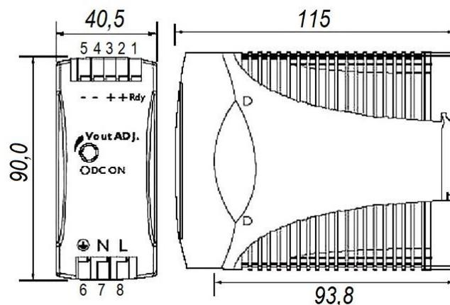
**Рисунок Д.10 – Блок питания постоянного тока DRAN30-24**
