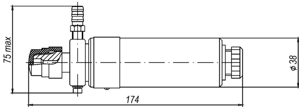
**Рисунок Д.8 – Датчики избыточного давления ДИ-017**
