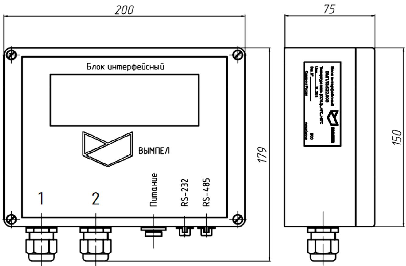
Рисунок Д.11 – Блок интерфейсный ВМПЛ3.622.003
