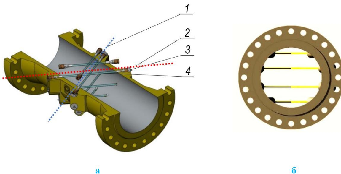
1, 2 – плоскости измерения; 3 – ДПЭ; 4 – ультразвуковой измерительный канал
