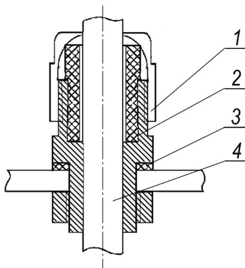
1 – контрящая гайка; 2 – уплотняющая резинка; 3 – корпус гермоввода; 4 - кабель
