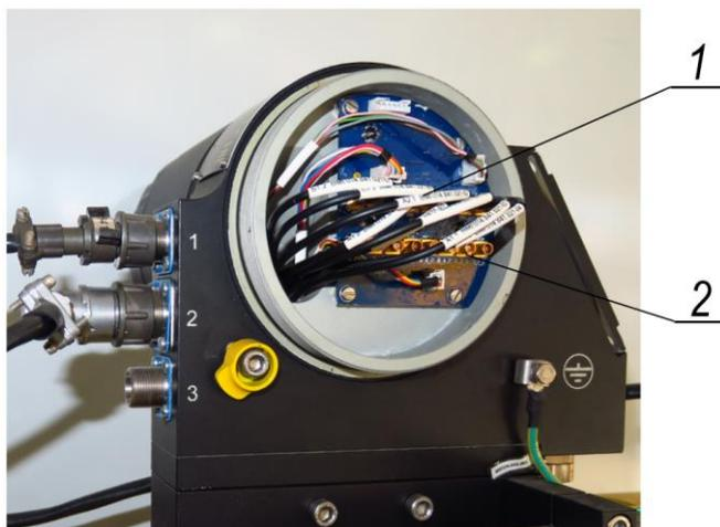
1 - кабели ДПЭ; 2 -разъёмы для подключения ДПЭ
