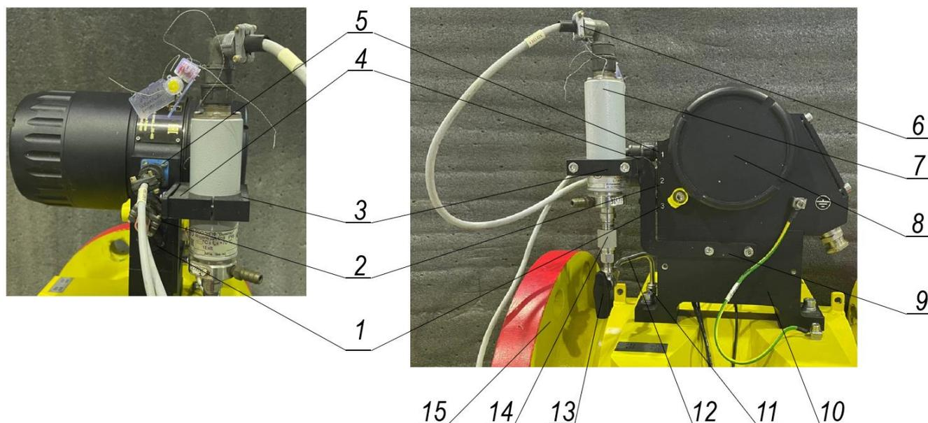
1 – разъём подключения внешних цепей; 2 – разъём для подключения ДД; 3 – верхняя часть хомута; 4 – нижняя часть хомута; 5 – разъём для подключения ТС; 6 – кабель ДД; 7 – ДД; 8 – БЭР; 9 – стойка ДД; 10 – стойка БЭР; 11 – штуцер; 12 – трубка бесшовная импульсная; 13 – отсечной кран; 14 – переходник; 15 – ИУ
