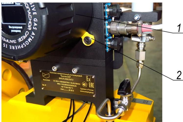
**1 – труба передней крышки; 2 – стопор с пломбой**
