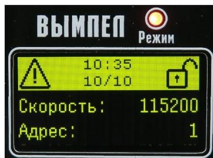
**Рисунок 29 – Окно параметров Modbus RTU (10/10).**
