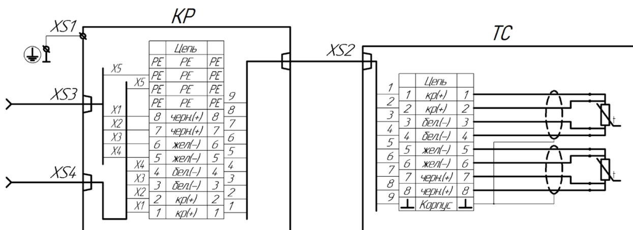
ТС – Термометр сопротивления с двумя чувствительными элементами ТСР012.53Сп
