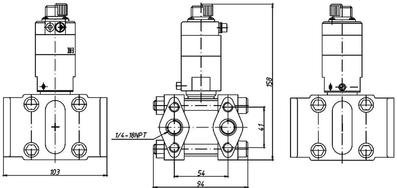
**Рисунок Д.9 – Датчики перепада давления ДП-022**
