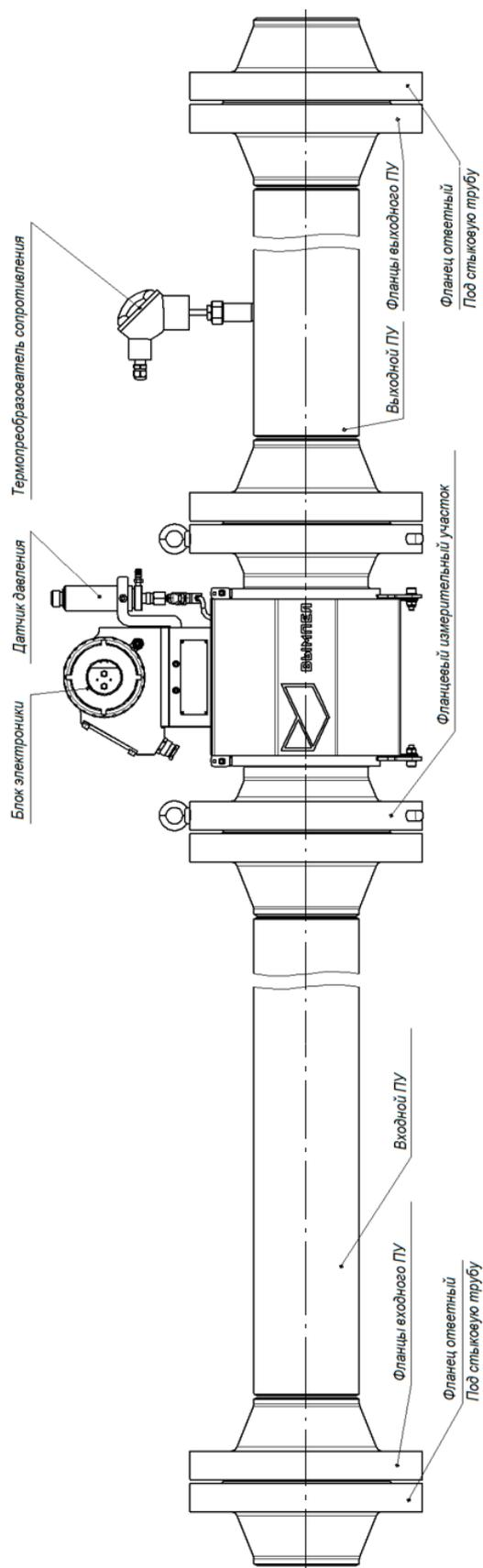
**Рисунок В.1 – Монтажная схема КИУ «Вымпел-500» с одним БЭР**
