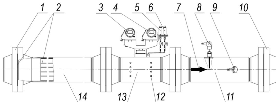
**1, 10 – ответные фланцы; 2 – формирователь потока (диск подготовки потока и струевыпрямитель); 3 – БЭР1; 4 – БЭР2; 5 – датчик давления БЭР1; 6 – датчик давления БЭР2; 7 – индикатор направления потока; 8 – ТС БЭР1; 9 – ТС БЭР2; 11 – выходной прямой участок; 12 – ультразвуковой пьезоэлектрический датчик; 13 – фланцевый преобразователь расхода; 14 – входной прямой участок**
