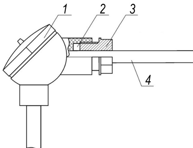
**1 – корпус ТС; 2 – втулка резиновая; 3 – контрящая гайка; кабель ВМПЛ4.841.098**
